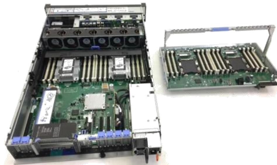
可拆卸的CPU和内存扩展托架
